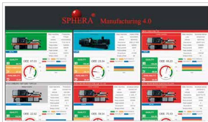
O.E.E. - O.L.E. con analisi delle perdite di performance e Andon con sinottico WEB delle macchine.
